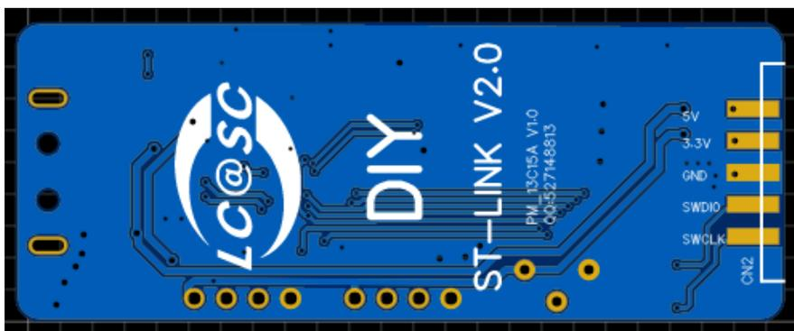
电路板时USB直接插电脑，识别位ST-LINK下载器，预留有STM32和STM8下载器通用接口。单电路板不做下载器时，可做STM32F103C8T6最小系统开发板，可自己写程序下载到开发板运行，也就时你做两块这样的板子就可以玩转STM32F103C8T6单片机。做开发板时可实现ADC，LED，PWM，IIC存储，串口通信，按键，USB虚拟设备等方面编程开发学习。
